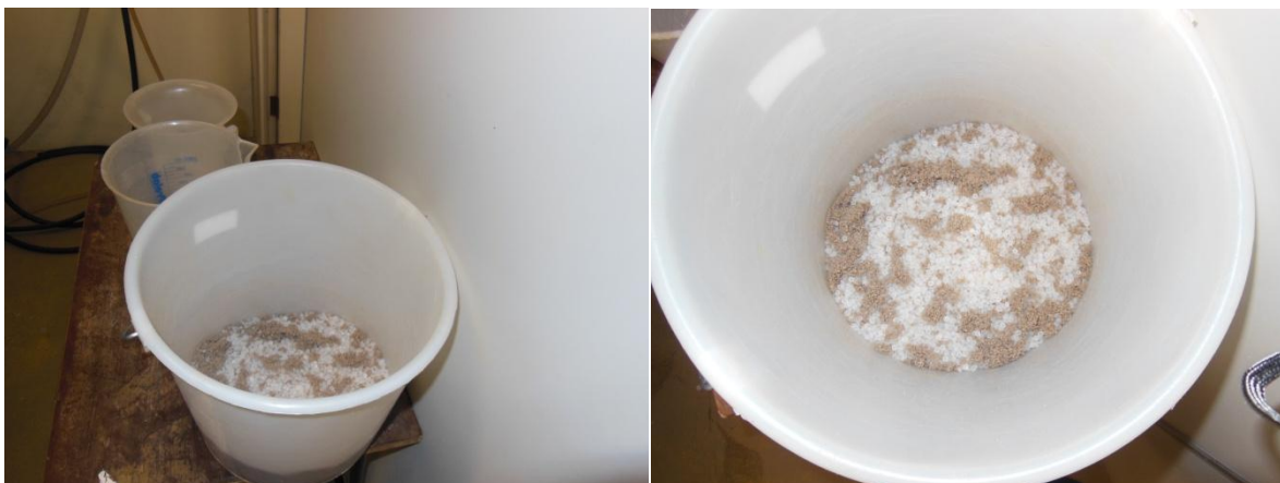
Figura 4.4 - Composição preparada para o processo de extrusão.
