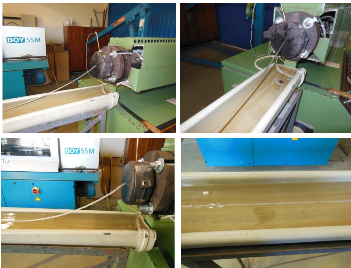
Figura 4.5 – Ilustração do processo de extrusão das composições.
