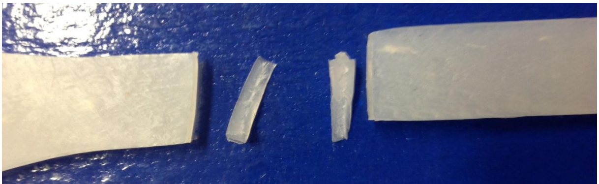
Figura 4.13 – Amostra sem fibra de papel preparada para ensaio MEV.
