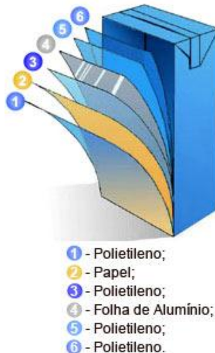
Figura 3.1 - Estrutura de formação de uma embalagem cartonada longa vida.
