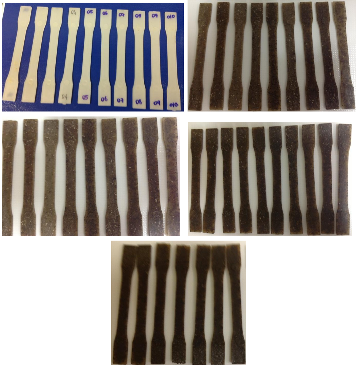
Figura 4.6 - Corpos-de-prova conformados para ensaio de tração. Composição 0% de fibra, 5%, 10%, 15% e 20% de fibra respectivamente.
