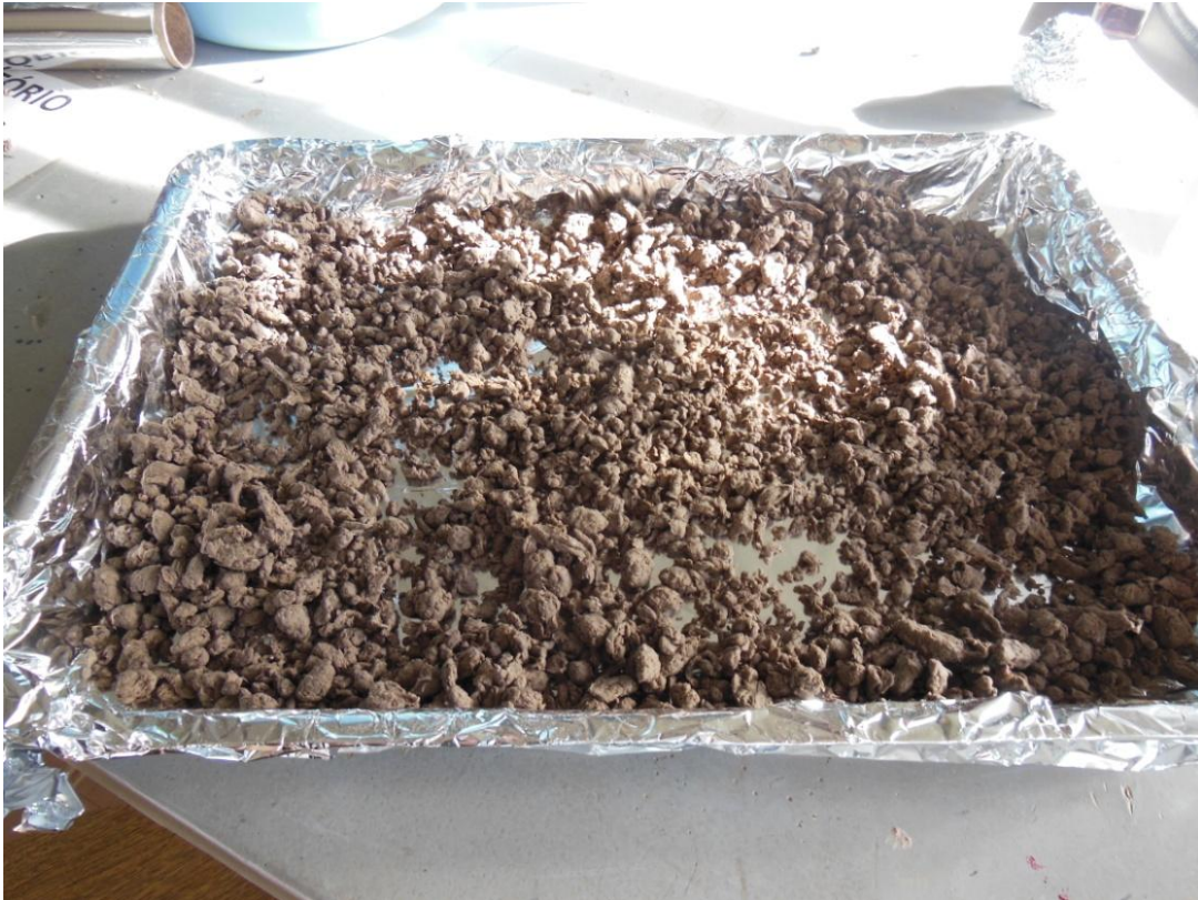
Figura 4.1 – Fibra de papel durante o processo de secagem.
