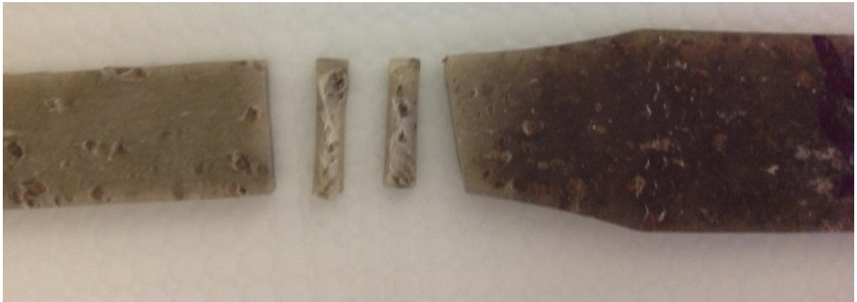
Figura 4.10 – Amostra com 15% de fibra de papel preparada para ensaio MEV.
