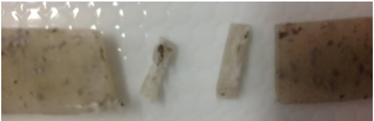
Figura 4.12 – Amostra com 5% de fibra de papel preparada para ensaio MEV.
