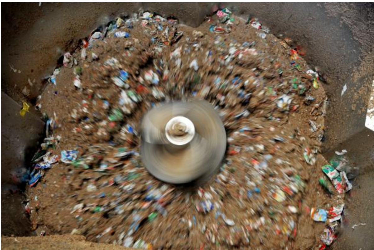
Figura 3.5 - Desagregação das embalagens cartonadas multicamadas.
