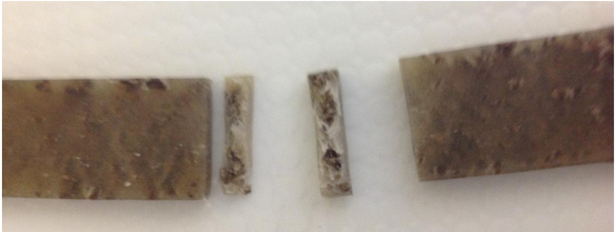
Figura 4.9 – Amostra com 20% de fibra de papel preparada para ensaio MEV.
