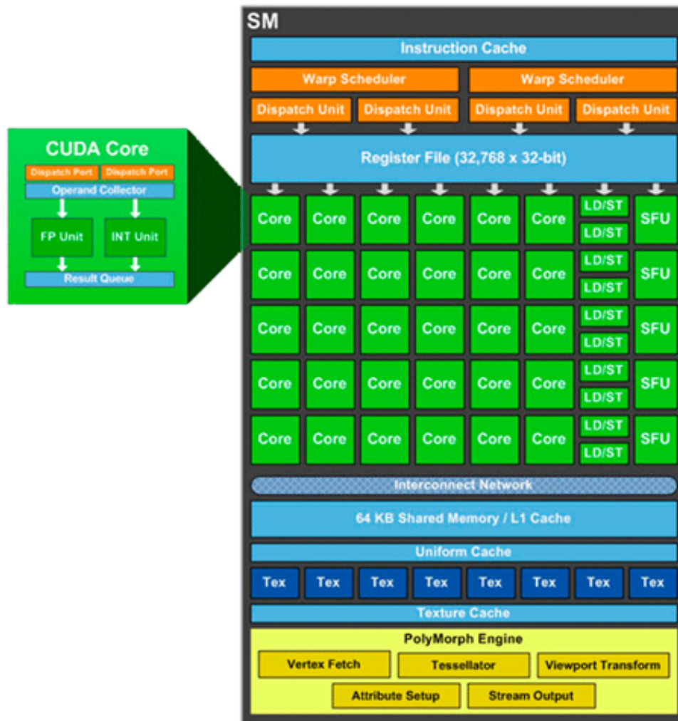
Figura 2: Multiprocessador da arquitetura Kepler
