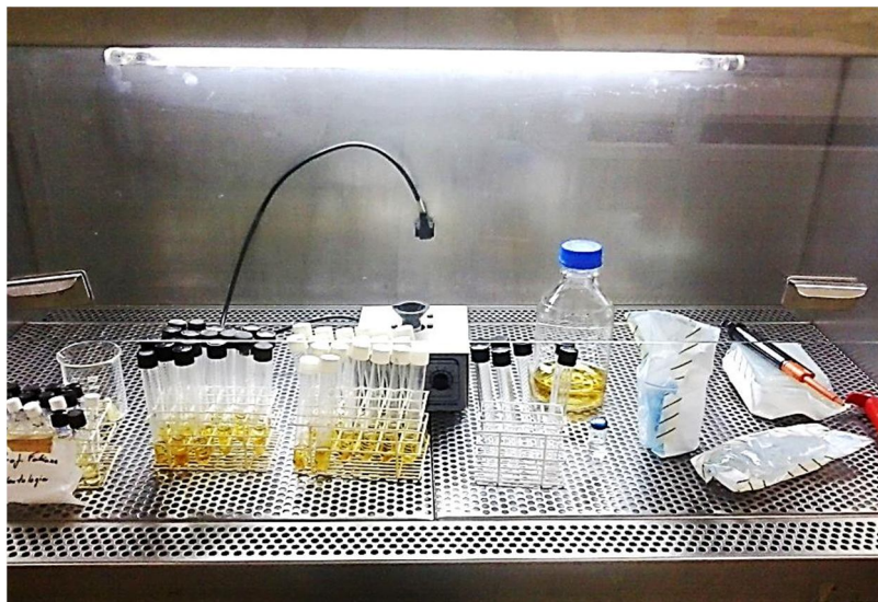
Figura 29: Substituição de caldo BHI a cada dois dias em câmara de fluxo laminar.
