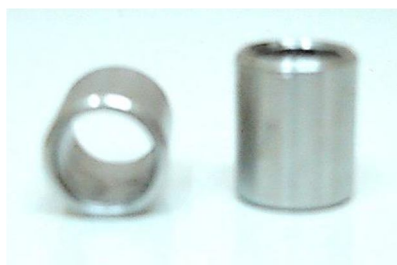
Figura 22: Cilindros metálicos para confecção de poços.
