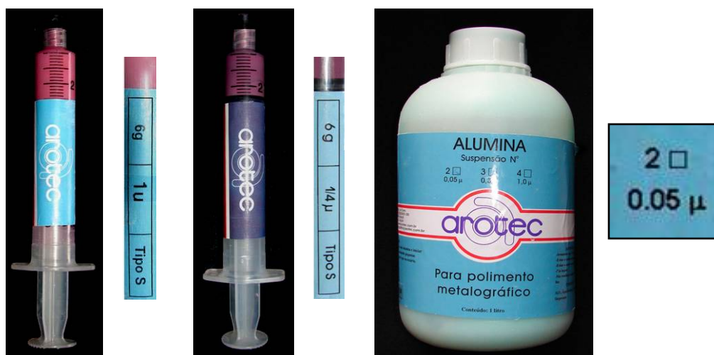
Figura 18. Seqüência de pastas diamantadas utilizadas no polimento com granulação decrescente 1\mu (rosa), 0,25\mu (roxa) e 0,05\mu (verde).
