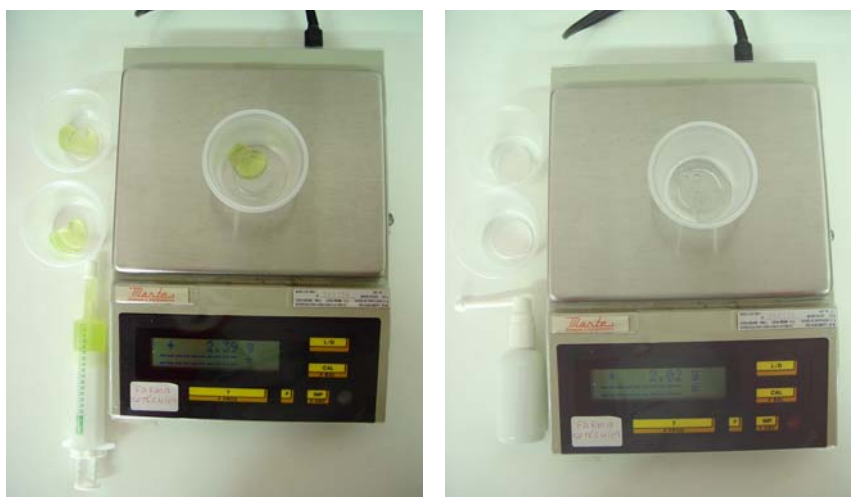
Figura 4 – Balança de precisão utilizada para obtenção da equivalência de massa entre gel e solução
