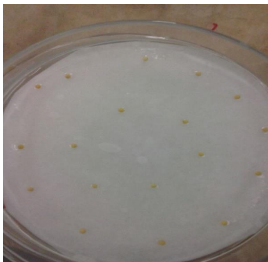
Figura 3: Ensaio de toxicidade utilizando semente de Sinapis alba (mostarda)
