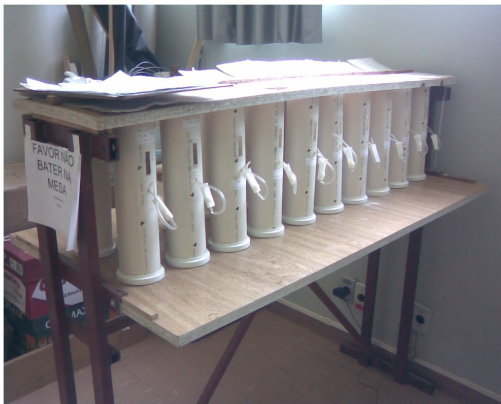
Figura 4.3: Tubos de PVC usados no processo de sedimentação natural.
