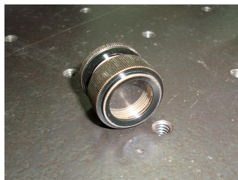
Figura 4.6: Porta-amostra utilizado nas medidas de FIL para solo pastilhado e em pó.
