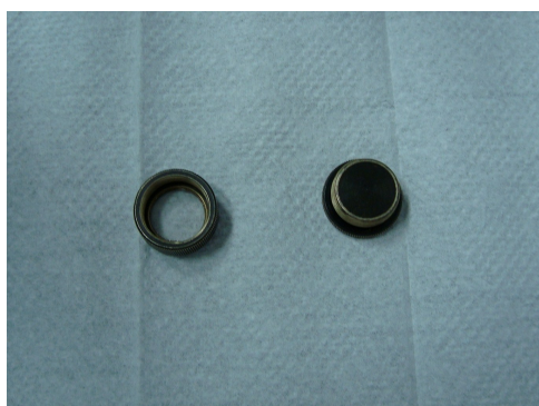
Figura 4.6: Porta-amostra utilizado nas medidas de FIL para solo pastilhado e em pó.
