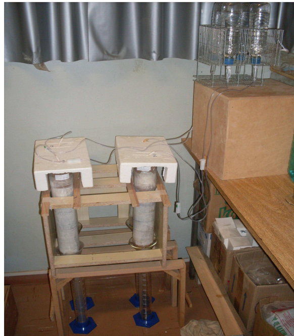
Figura 4: Sistema utilizado para aplicação de água nas colunas de solo. Fonte: autoria própria, 2010.
