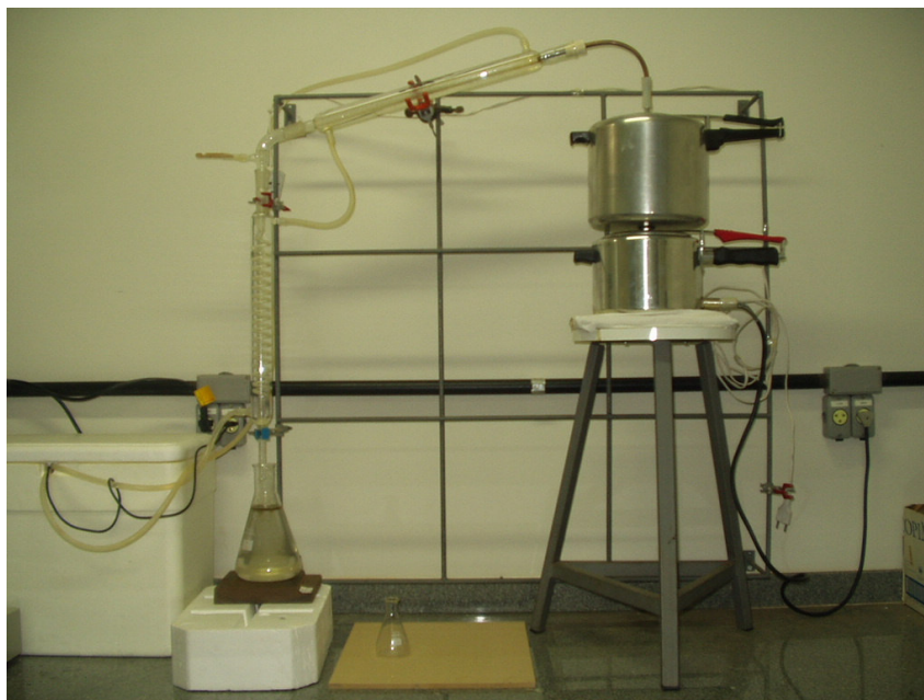
Figura 4 – Extração do óleo essencial por arraste a vapor
