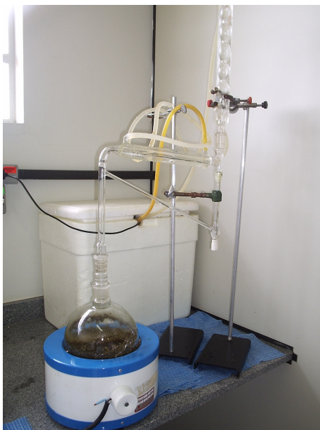
Figura 3 – Extração do óleo essencial por hidrodestilação
