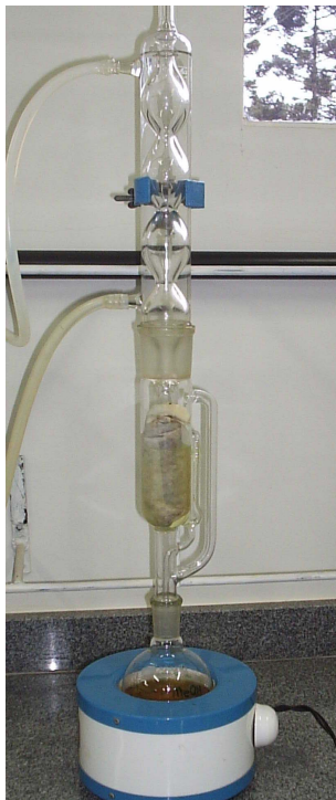
Figura 5 – Aparelho de Soxhlet utilizado para extração por seqüência de solventes com polaridade crescente
