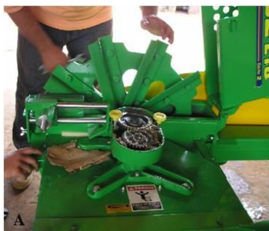
Figura 4- Configuração do rotor de corte com 10 lâminas (A). Engrenagens utilizadas para obtenção de diferentes comprimentos teóricos de fragmentos (B)
