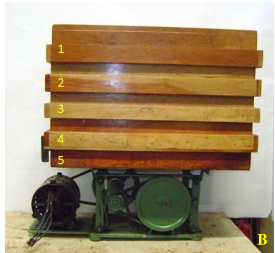
Figura 5- Peneiras utilizadas para a determinação do tamanho de fragmento no ensaio (A). Agitador e posição das peneiras (B)
