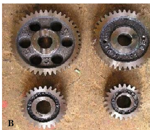
Figura 4- Configuração do rotor de corte com 10 lâminas (A). Engrenagens utilizadas para obtenção de diferentes comprimentos teóricos de fragmentos (B)
