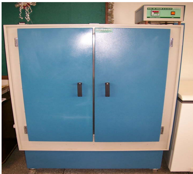
Figura 1. Secador de ar forçado. Laboratório de Tecnologia de Alimentos, Departamento de Engenharia de Alimentos, UEPG, Ponta Grossa, Paraná, 2007.
