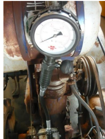
FIGURA 5. Manômetro para avaliação de pressão da compressão
