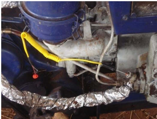
10a. Sensor termopar instalado na entrada da bomba injetora
