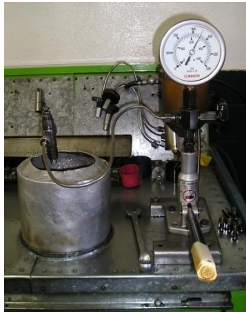
FIGURA 4. Bancada de ensaio de bicos injetores
