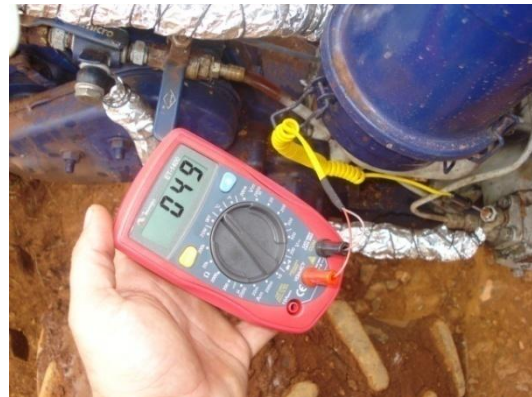
10b. Multímetro utilizado para a leitura do termopar
