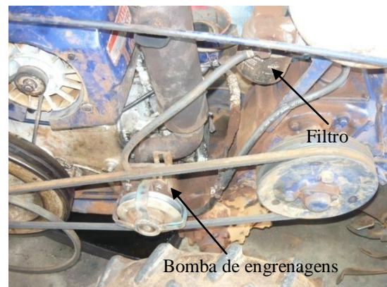
7b. Bomba de óleo vegetal combustível e filtro
