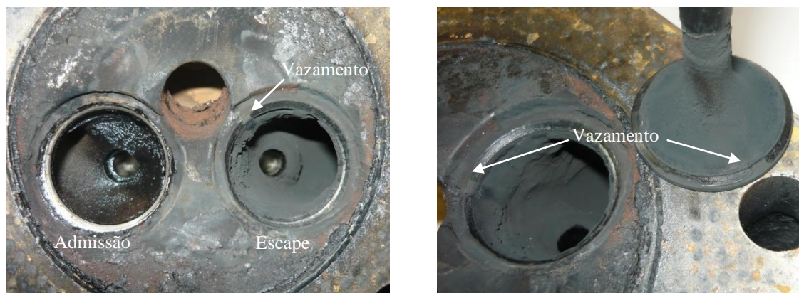
FIGURA 16. Vazamento de pressão pela válvula de escape do E-2
