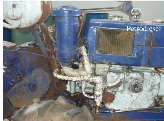
8b. Detalhe das válvulas de escolha de combustível
