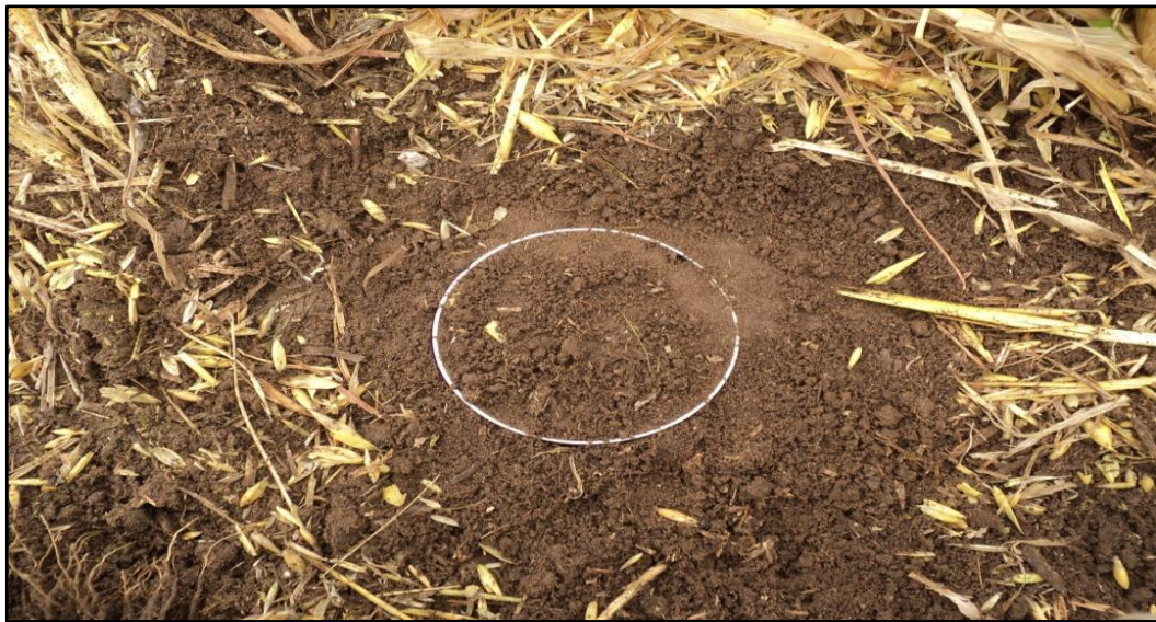
Figura 7: Ilustração da coleta de amostras de solo na camada superficial (0,00 – 0,05m).
