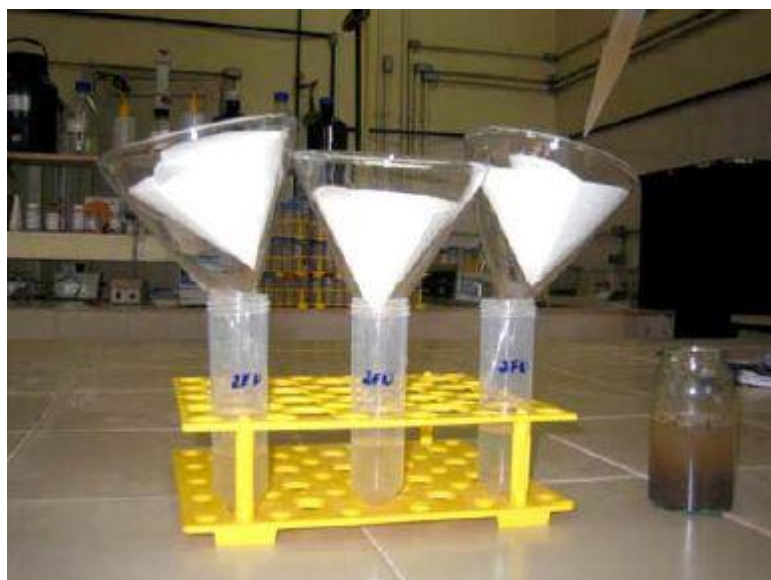
Figura 5. Amostras sendo filtradas após agitação com sulfato de potássio para extrair o C da massa microbiana. Fonte (Silva et al.,2007)
