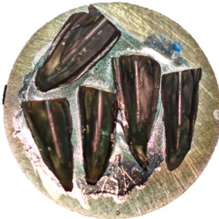
Figura 7 – Amostra metalizada para avaliação dos túbulos dentinários por MEV.
