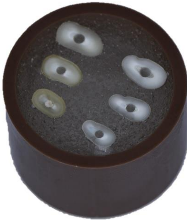
Figura 14 – Fatias embutidas em resina acrílica para realização do teste de microdureza.
