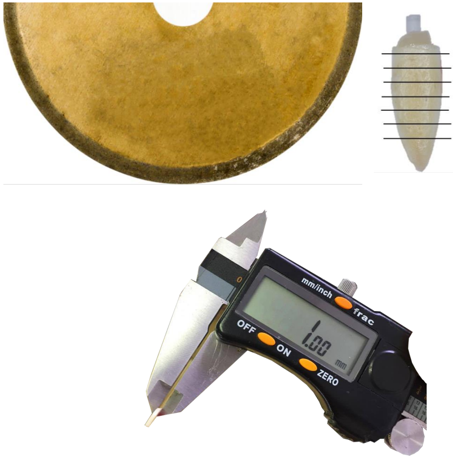
Figura 9 – Preparo dos corpos de prova. (A) Corte das raízes em seis fatias; (B) mensuração da espessura com auxílio do paquímetro digital.
