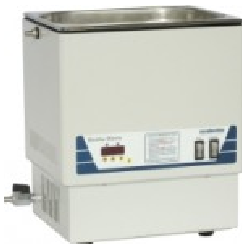
Figura 16 – Banho termostático com circulação interna e externa do líquido através de bomba de demanda, com vazão de 10L/min. Sistema de aquecimento através de resistência tubular de 1000 W e sensor de temperatura tipo PT 100. Fonte: fabricante.
