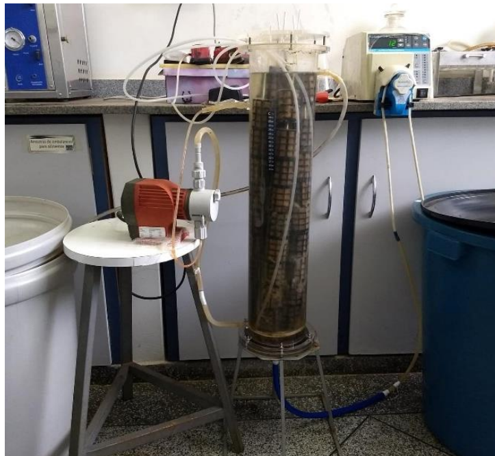
Figura 3 - Fotografia do reator e seus equipamentos.
