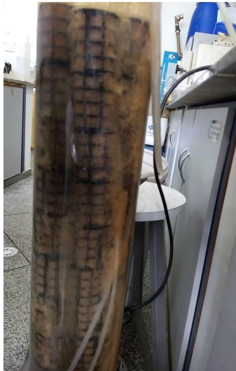
Figura 5 - Biofilme aderido aos Biobobs® presentes no interior do reator.
