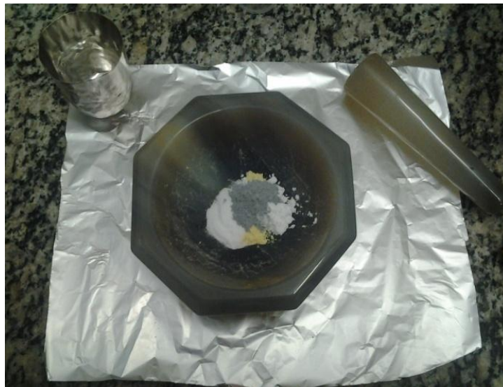
Figura 11 – Foto de cadinho de platina e almofariz de ágata com pós precursores.
