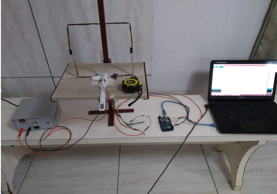
Figura 16 - Regulador de tensão, paquímetro, sensor, arduino e notebook.
