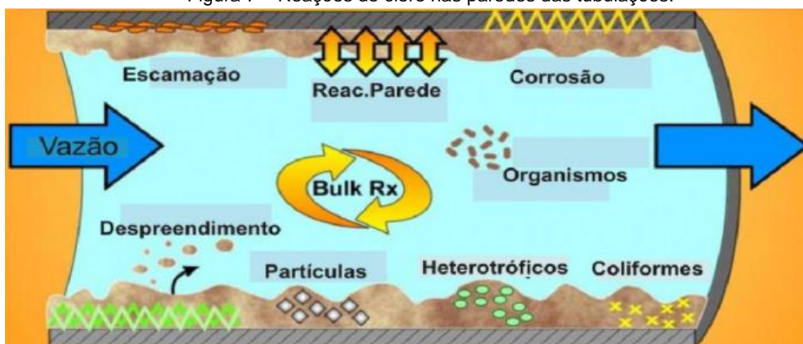
Figura 7 – Reações do cloro nas paredes das tubulações.
