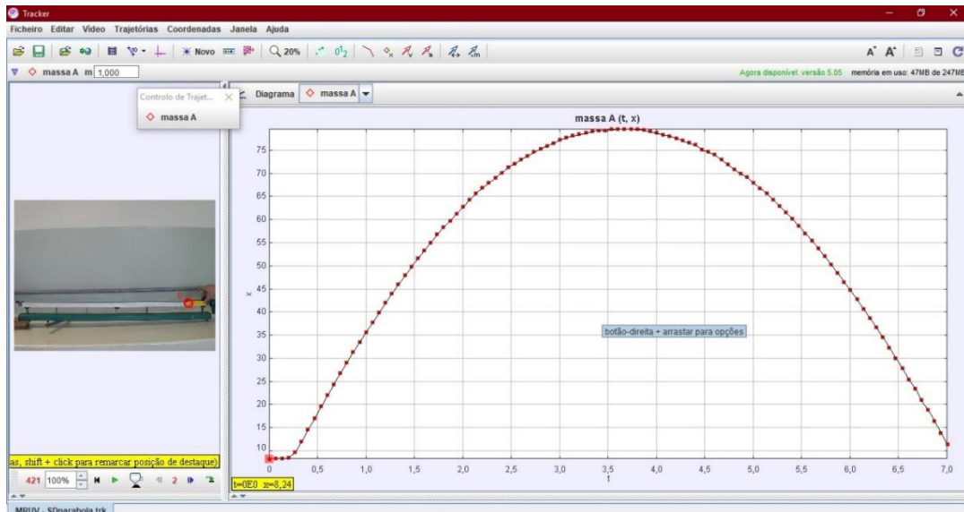
Figura 5- Gráfico de posição x tempo ampliado. O frame inicial se os quatro seguintes indicam a impulsão sofrida pelo carrinho causada pela mola.
