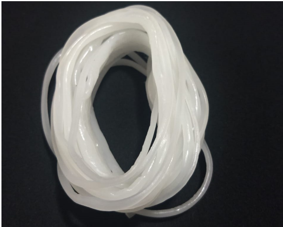
Figura 11 –Blenda após extrusora: 80% Elastômero e 20% Polipropileno
