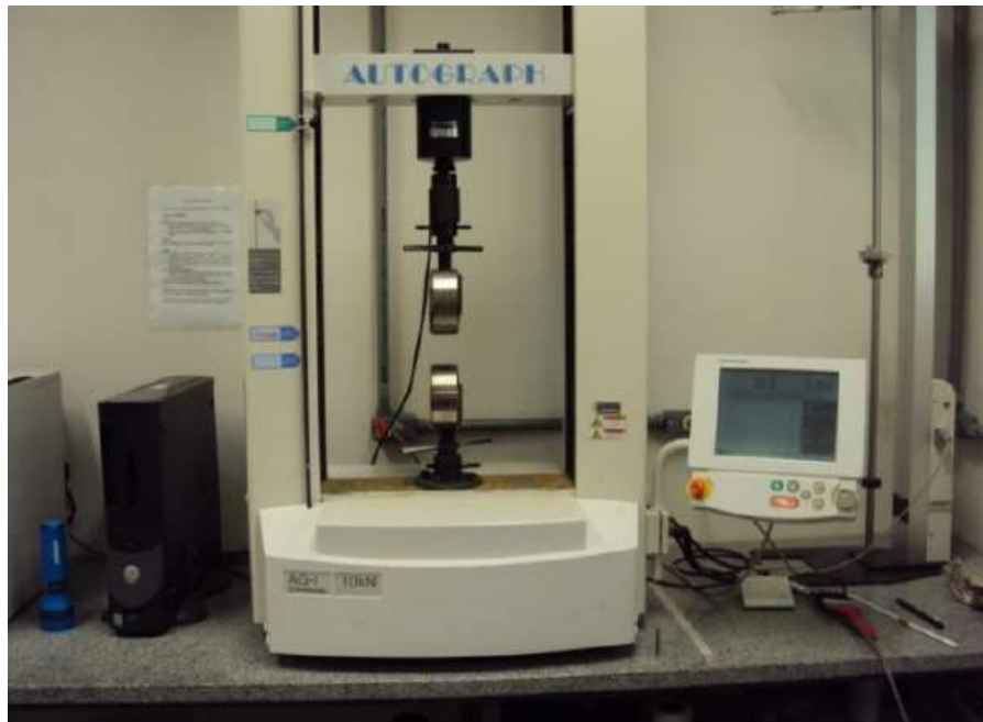
Figura 21 –Equipamento de ensaio de Tração SHIMADZU AG-1
