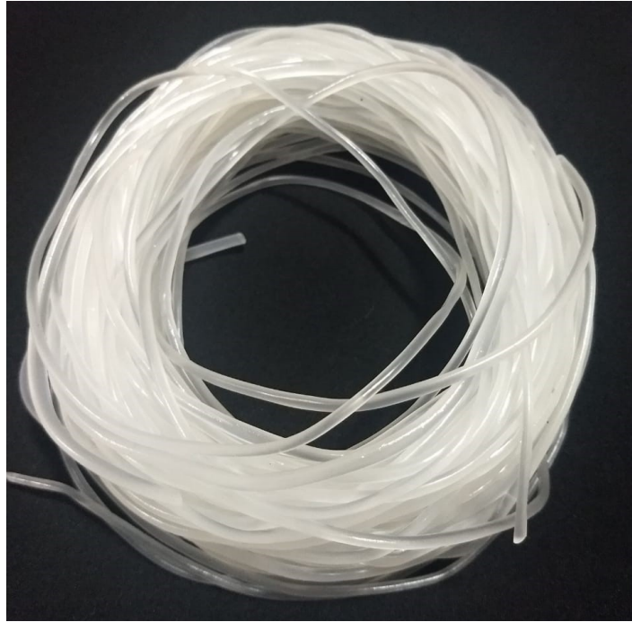
Figura 10 –Blenda após extrusora: 90% Elastômero e 10% Polipropileno
