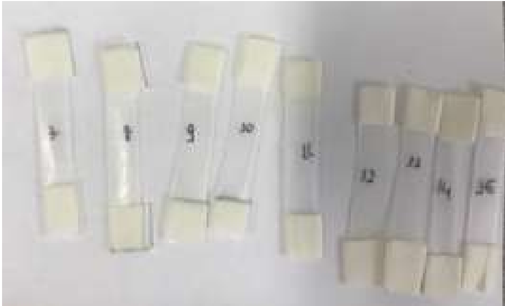
Figura 22 –Corte e corpo de prova para ensaio de tração (0,5 mm x 50 mm)
