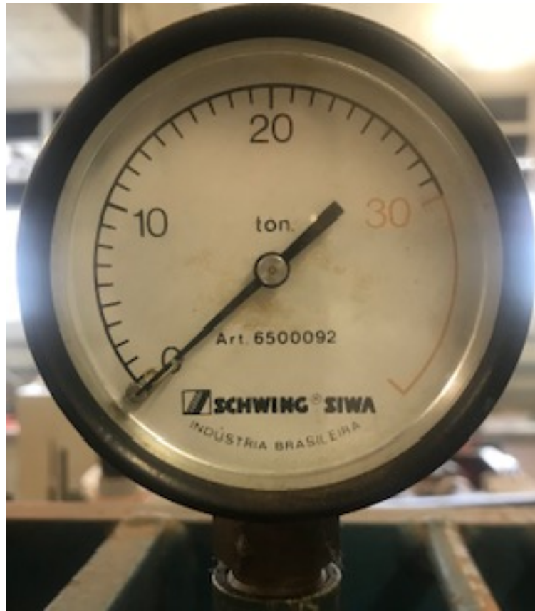
Figura 16 –Manômetro de pressão prensa hidráulica 0 a 30 toneladas
