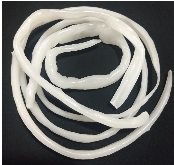
Figura 12 –Blenda após extrusora: 70% Elastômero e 20% Polipropileno
