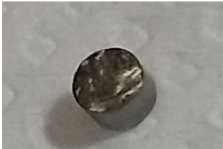
Figura 14 –Amostra polimérica impregnada com PTA 5% e recoberta com ouro
