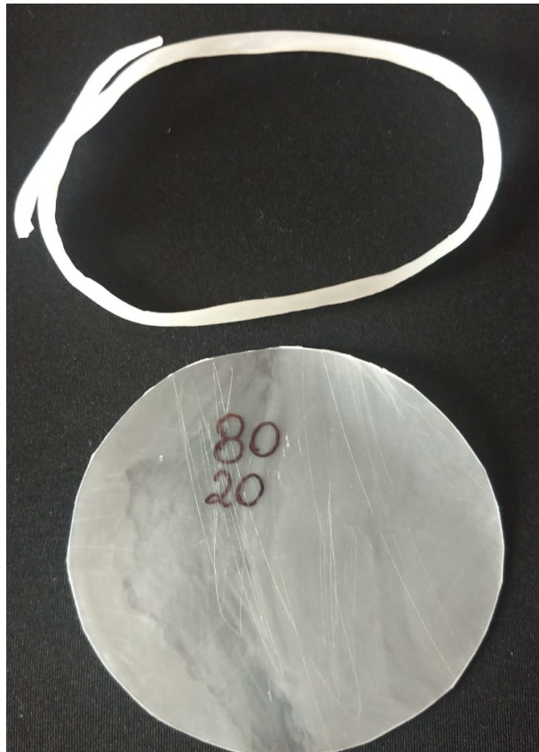
Figura 19 –Corpo de prova e Tela na proporção de: 80% Elastômero e 20% PP
