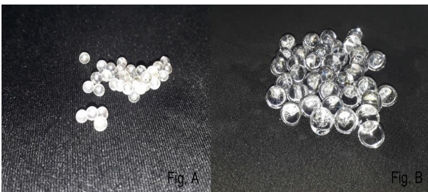
Figura 24- Bolinhas de gel. A: Bolinhas de gel sem estarem dilatadas. Figura B: Bolinhas de gel com volume maior após imersão em água.
