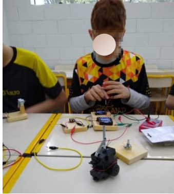
Figura 32: Registro de um aluno utilizando um multímetro para medir tensão nas pilhas utilizadas no circuito
