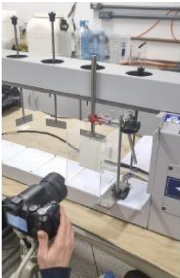
(A) Posição da câmera e do alvo de calibração, foto em jarro único com o laser desligado
