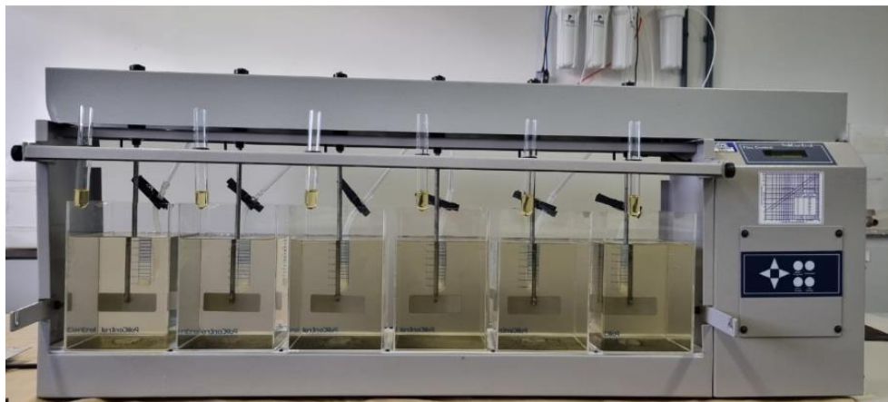
Figura 5 – Processo de determinação das dosagens ótimas dos reagentes, equipamento Jar Test.
