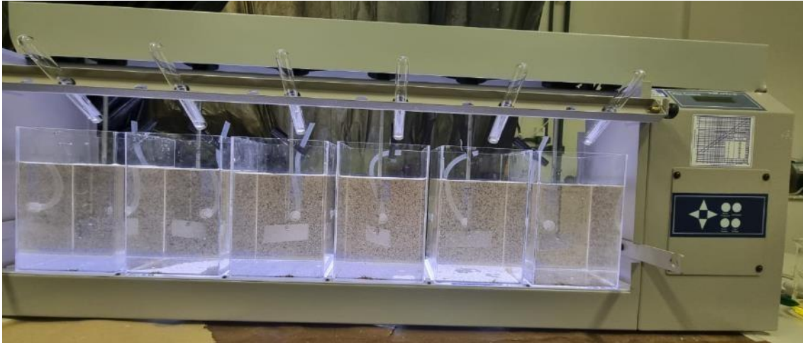
Figura 9 – Jar test em tratamento convencional, com água bruta e PAC, iniciando formação de flocos.
