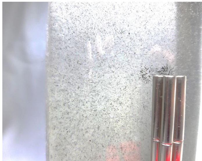
Limalha dentro da garrafa com líquido viscoso submetida à campo magnético
