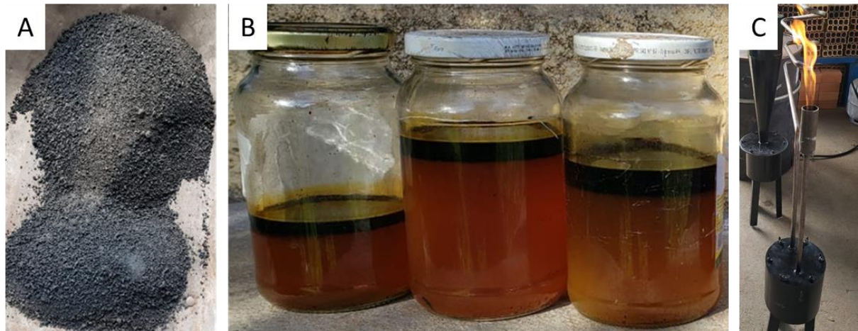
Figura 7 – Detalhes do biochar produzido na sétima versão do pirolisador (A), bio-óleo coletado (B) e biogás em combustão (C).
