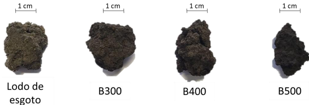
Figura 9 – Detalhes do lodo de esgoto e do biochar obtido em diferentes temperaturas de pirólise.
