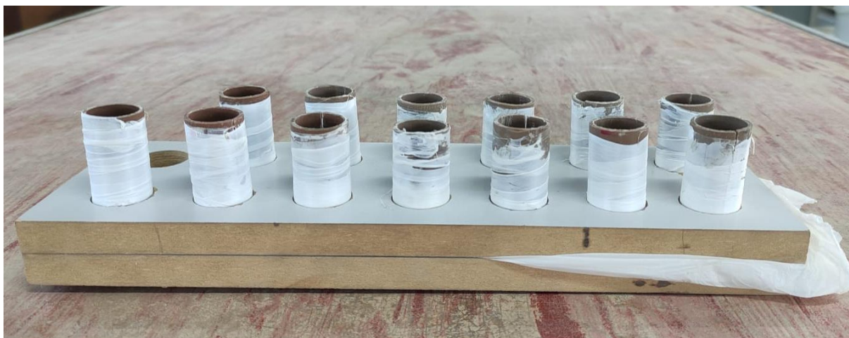
Figura 22 – Fôrmas utilizadas para a moldagem dos corpos de prova.
