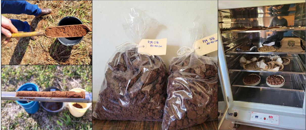
Figura 3 - Coleta e preparo de amostras de solo para análise dos atributos químicos.
