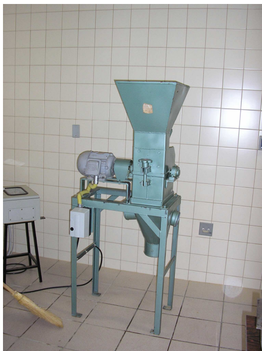
Figura 2 – Moinho de beneficiamento da farinha de bagaço de maçã
