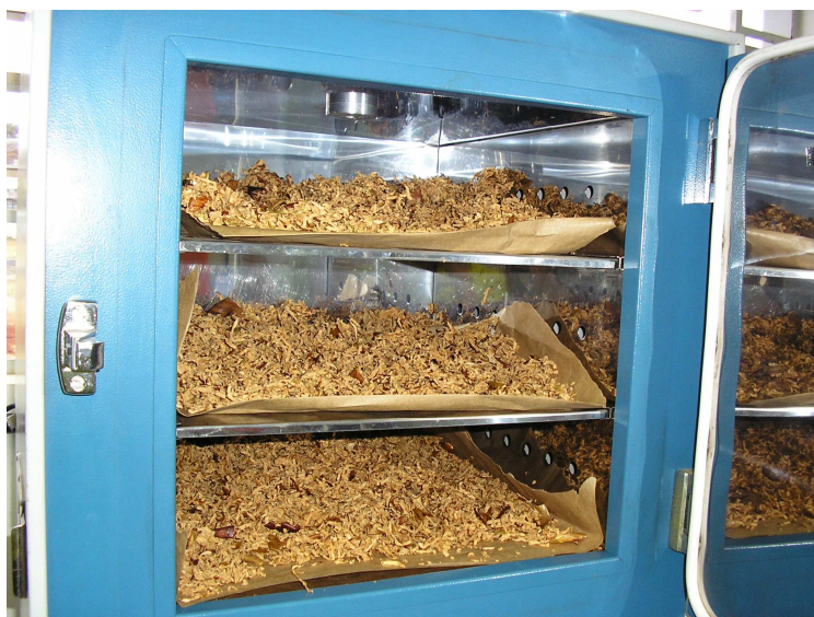
Figura 1 – Secagem do bagaço de maçã em estufa
