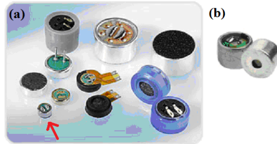
Figura 3.7 – (a) Modelos mais comuns de microfones de eletreto, destacando o microfone utilizado na OPC. (b) Visão detalhada do microfone de eletreto utilizado na OPC [22, 24] (figuras modificadas).
