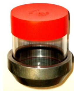
Figura 16 - (a) Relação das amostras utilizadas para cada sistema de manejo e suas respectivas camadas coletadas; (b) Foto de um tubo de acrílico similar àqueles utilizados na presente pesquisa. Este apresentado aqui possui dimensões de 6,4 cm e externo de 7,0 cm, com 7,5 cm de altura.
