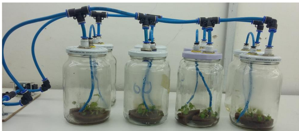
Figura 24 - Biorreator com recipientes de 500 ml
