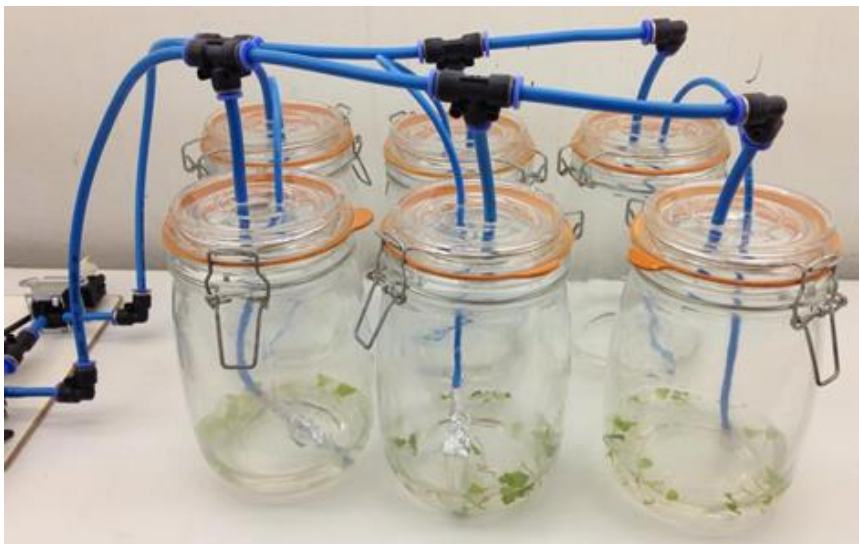
Figura 23 - Biorreator com recipientes de 1l
