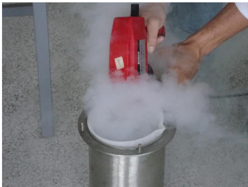
Figura 14 – Fotografia da amostra sendo pulverizada no nitrogênio líquido. FONTE: O Autor.
