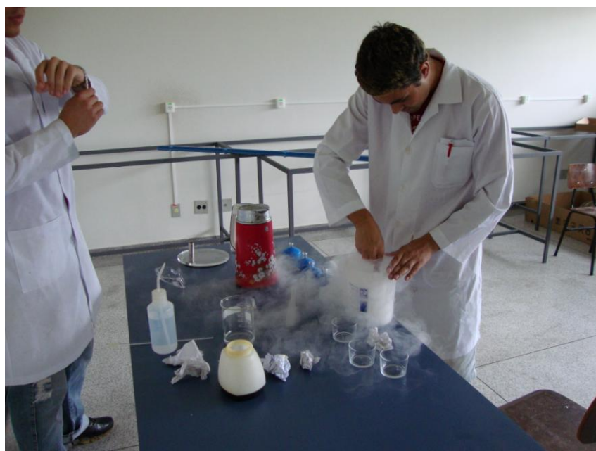
Figura 15 – Fotografia da retirada da solução + nitrogênio líquido sendo retirado do béquer e colocado nos frascos do liofilizador FONTE: O Autor.
