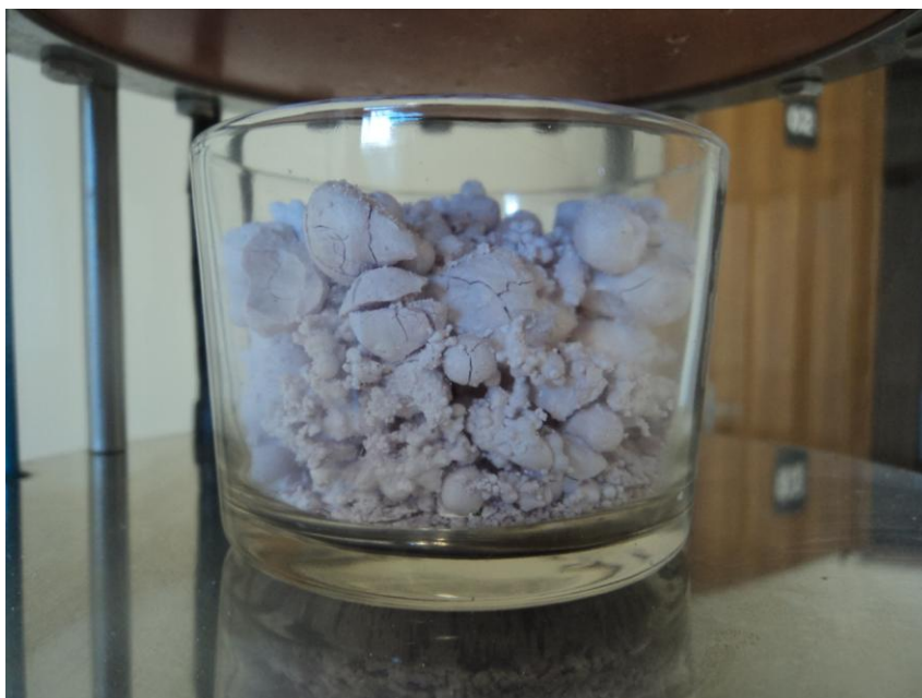
Figura 19 – Fotografia do frasco de vidro durante processo de liofilização na bandeja do liofilizador. FONTE: O Autor.
