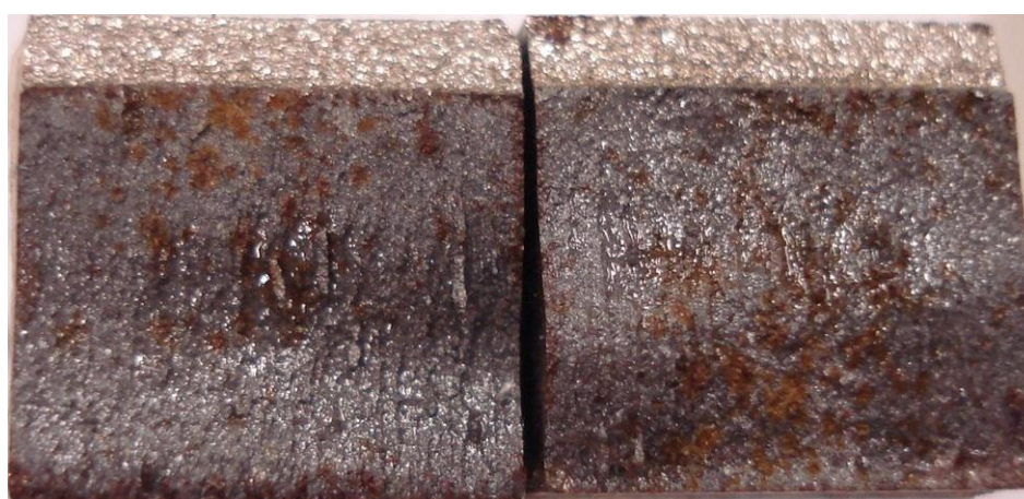
c) Temperatura de ensaio: -196°C, Energia absorvida 5J
