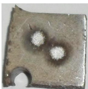
Figura 5. 1- Queima realizada na amostra para obtenção da composição química
