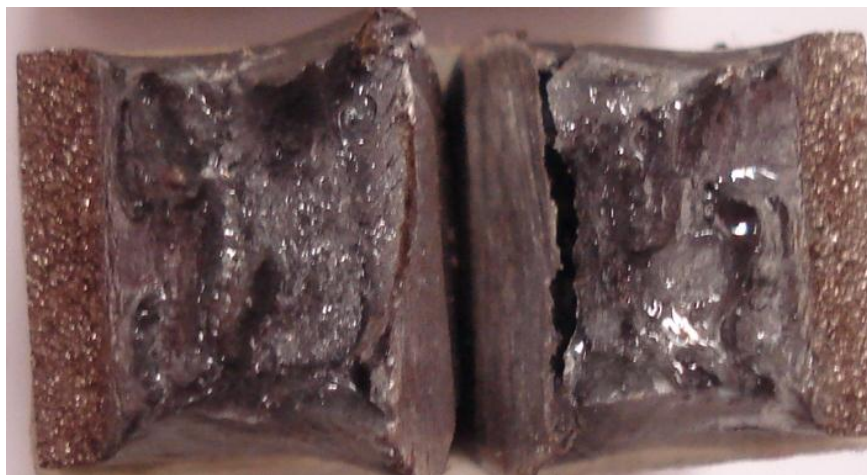
a) Temperatura de ensaio: 27°C, Energia absorvida: 277 J
