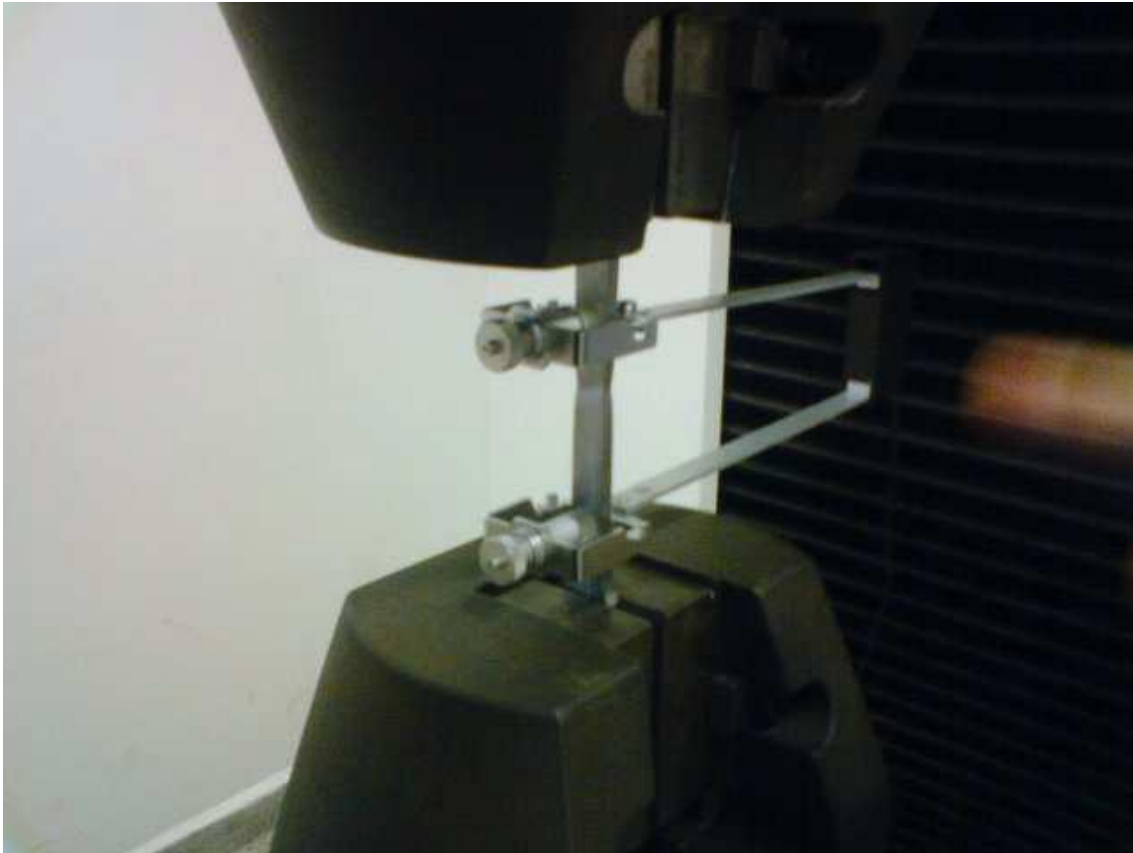
Figura 4.2- Ensaio de tração do aço API 5L X 70
