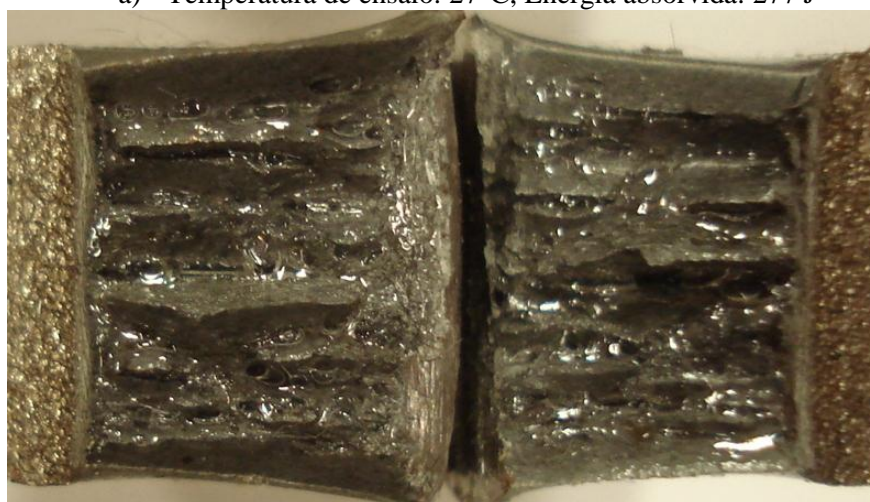
b) Temperatura de ensaio -29°C, Energia absorvida 131 J
