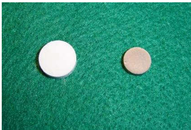
Figura 4.1 Fotografia de duas pastilhas de mesma composição: antes (com 13mm de diâmetro) e após da sinterização.
