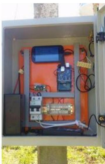
**Figura 5:** Visão interna do protótipo inicial da estação agrometeorológica.
