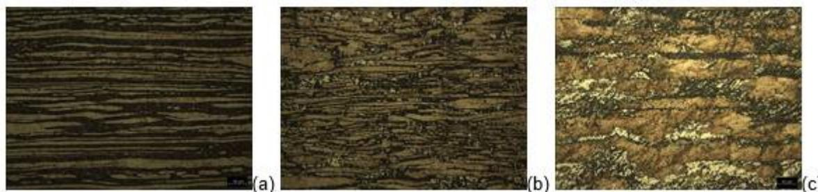
Com as imagens obtidas foi feita a montagem de um cubo, mostrado na figura 26, que ilustra melhor a disposição dos grãos dentro do material, que será seguida posteriormente na confecção dos corpos de prova utilizados para a extrusão por canal angular. Com esta montagem observa-se o formato dos grãos alongados e bastante achatados nas seções transversal e longitudinal.
