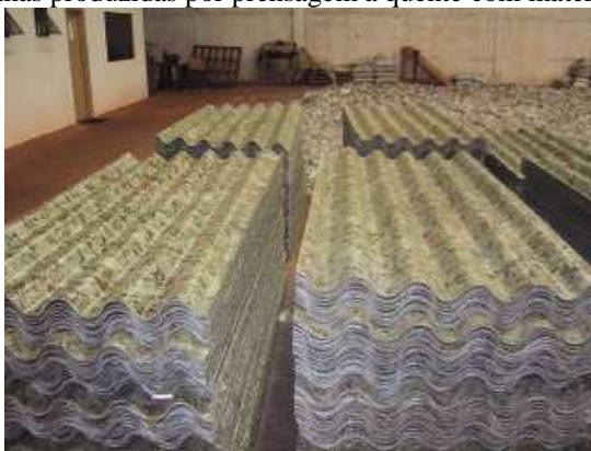
Figura 3.5 – Telhas produzidas por prensagem a quente com material reciclado(11).
