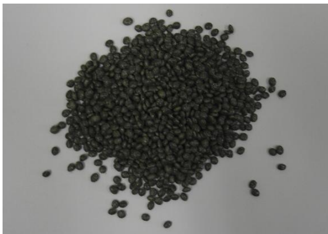
Figura 3.3 – Imagem do resíduo PEBD/Al peletizado.
