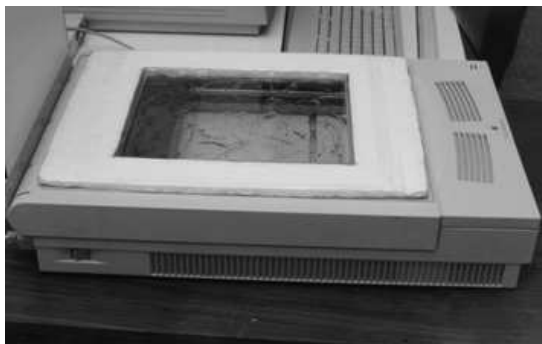
Figura 7. Imagem do scanner para aquisição com bandeja de vidro e borda de isopor.
