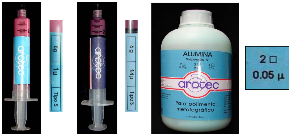
Figura 10 – Seqüência de pastas diamantadas (Arotec) utilizadas no polimento das amostras, granulação decrescente 1\ \mu\text{m} (rosa), \frac{1}{4}\ \mu\text{m} (roxa) e 0,05\ \mu\text{m} (verde).
