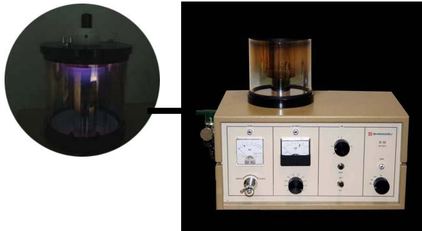
Figura 13 – Metalizador (Shimadzu, Kioto, Japão) para as amostras do MEV (Shimadzu, Kioto, Japão) o detalhe à esquerda mostra o equipamento em funcionamento.
