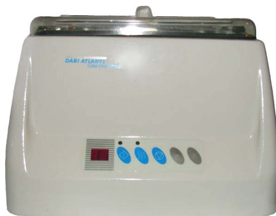
Figura 11 – Cuba ultra-sônica Dabi Atlante - 3L utilizada nos banhos entre os agentes polidores.
