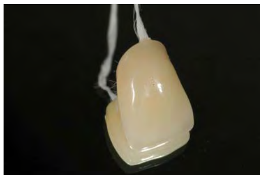
Figura 2 - Corpos-de-prova com fio dental na região cervico-palatina.
