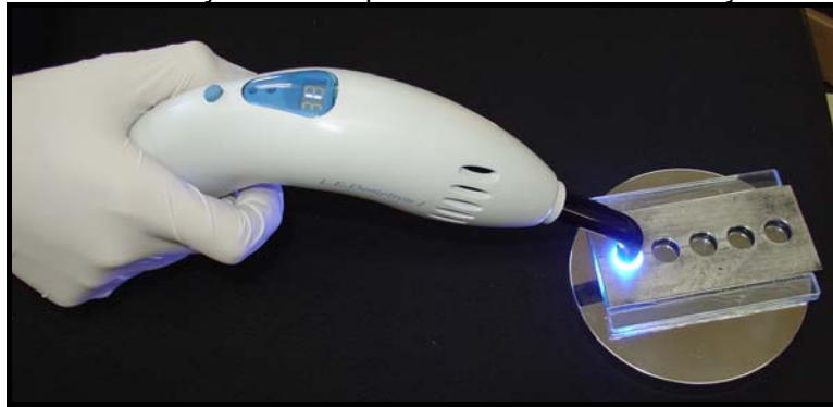
Figura 10 - Esquema de colocação dos componentes antes da fotoativação dos corpos-de-prova
