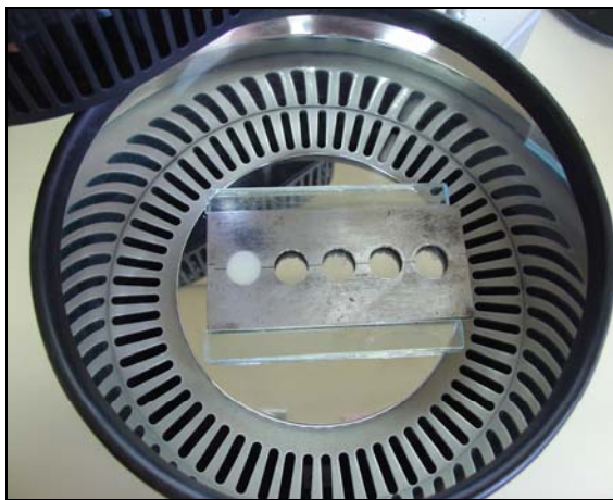
Figura 12 – Fotoativação do corpo-de-prova no aparelho Strobolux
