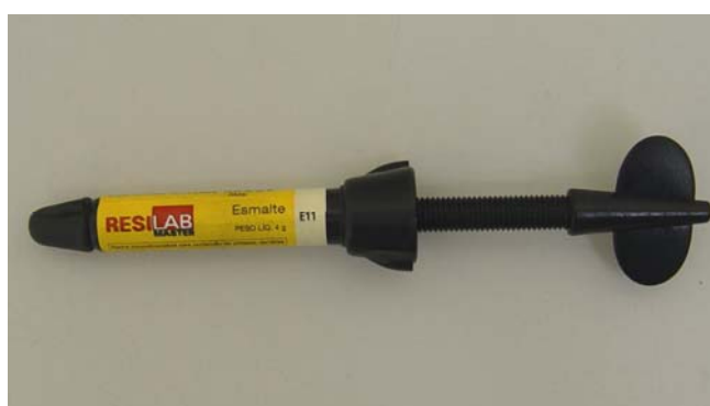
Figura 9 - Resina Laboratorial de Segunda Geração Resilab Master (Wilcos), utilizada na confecção dos corpos-de-prova do Grupo 3.
