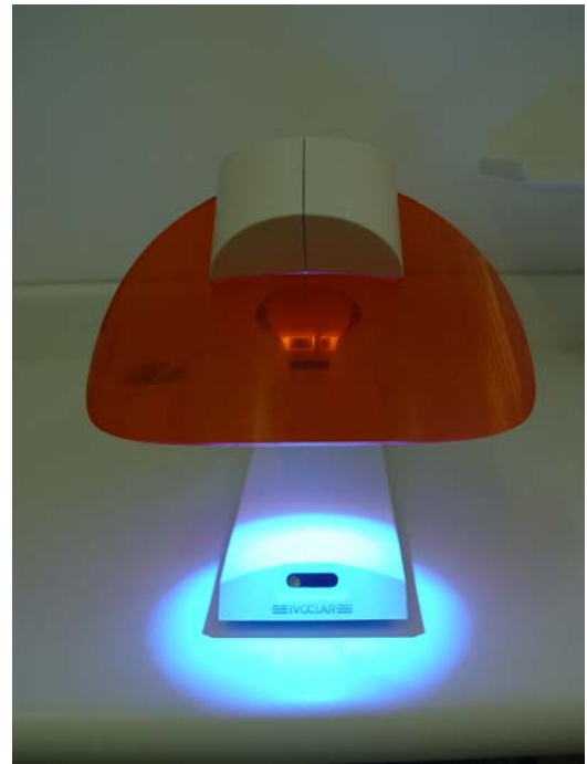
Figura 7 - Unidade Polimerizadora Targis Quick (Ivoclar/Vivadent) onde se realizou a polimerização inicial dos corpos-de-prova do Grupo 2.
