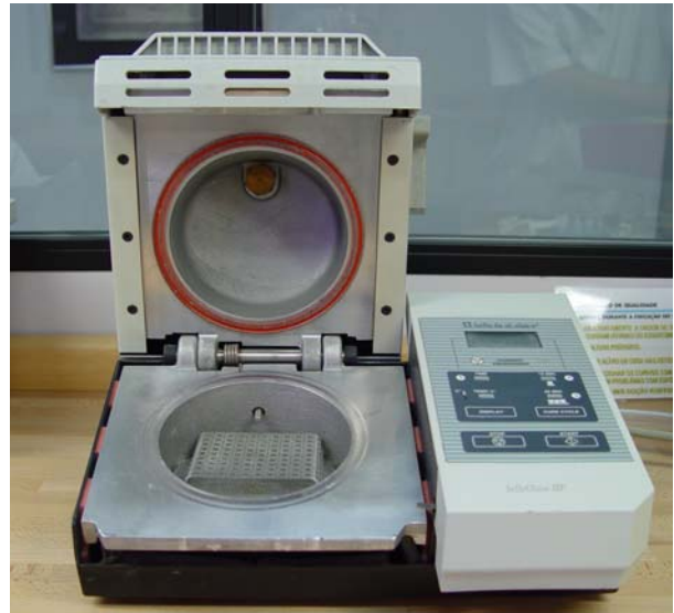
Figura 13 - Curing Unit (Kerr), unidade polimerizadora específica do material restaurador belleGlass HP (Kerr), que combina calor, pressão e presença de nitrogênio.
