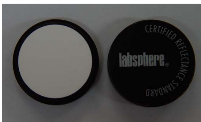
Figura 18 - Padrão branco fornecido pelo fabricante para correção de linha de base.
