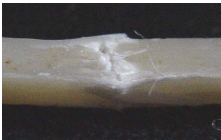
Figura 16 - Fratura incompleta observada na Fibra de Vidro Unidirecional Fibrex Medial ® (Angelus).
