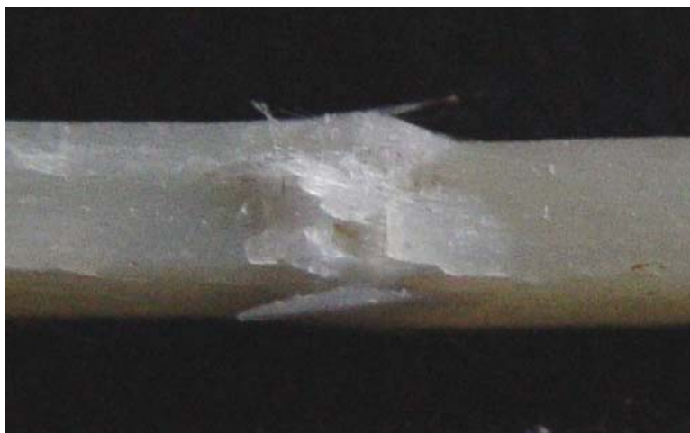
Figura 15 - Fratura incompleta observada na Fibra de Vidro Unidirecional Vectris Pontic ® (Ivoclar/Vivadent).
