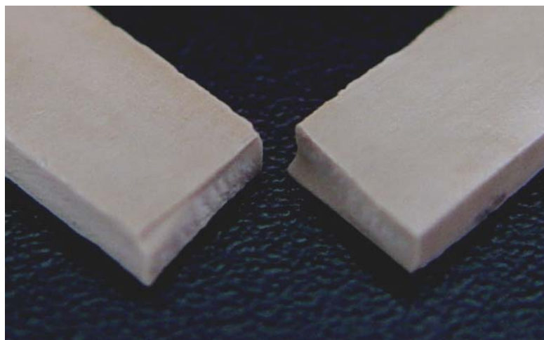
Figura 18 – Fratura completa observada na Cerâmica VITA In-Ceram ® Zircônia.
