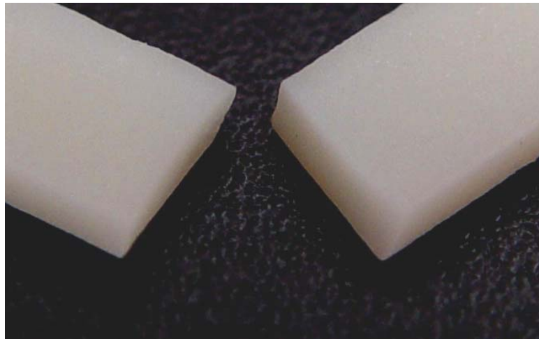
Figura 17 – Fratura completa observada na Cerâmica IPS Empress ® 2 (Ivoclar/Vivadent).
