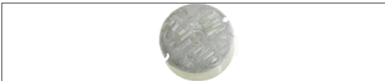
Figura 10 - Stub com palitos lixados previamente à leitura no micro-Raman. Isto facilita a localização da camada híbrida.
