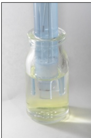
Figura 13 - Análise de pH. Vista do eletrodo totalmente submerso na solução para a leitura do pH do adesivo após 12 h de armazenamento em escuridão.
