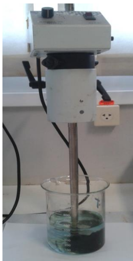
Figura 4 Sistema de degradação utilizando-se ferro de valência zero ( \text{Fe}^0 ).
