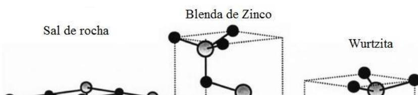
Segundo Shi, et al. (2014) e Kulkarni, et al. (2011) dentre as três estruturas, a mais comum e termodinamicamente estável é a wurtzita onde o seu cristal tem estrutura hexagonal e cada átomo de zinco é coordenado tetraédricamente com quatro átomos de oxigênio.
