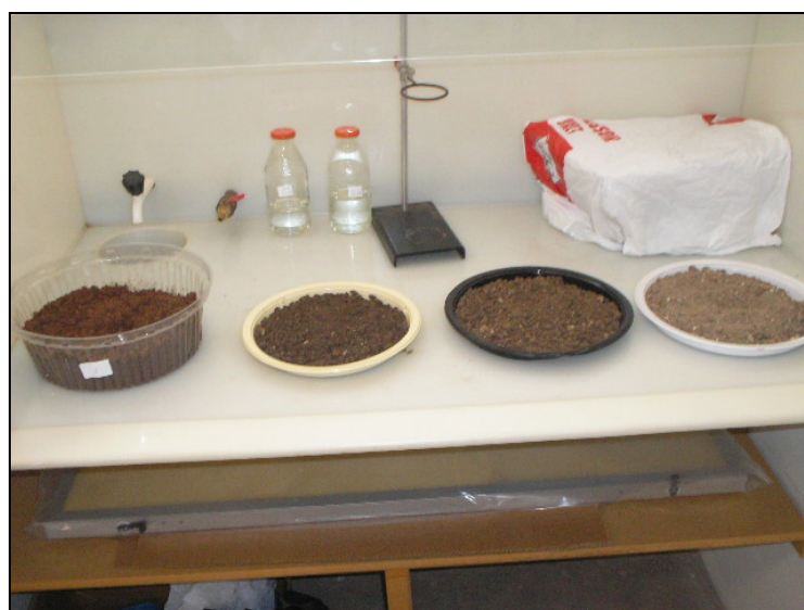
FIGURA 30: Amostras de solo sendo secas na capela. Fonte: Autoria própria, 2006.
