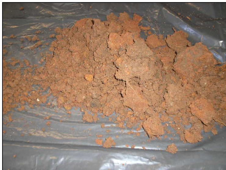
FIGURA 29: Amostra de solo antes da catação e secagem. Fonte: Autoria própria, 2006.
