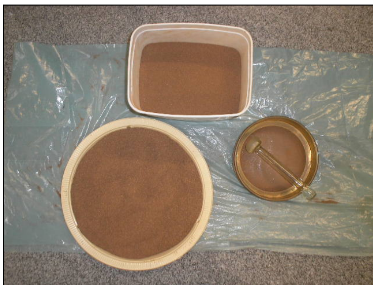
FIGURA 31: Amostra de solo triturada e peneirada em malha de 0,297 mm Fonte: autoria própria, 2006.
