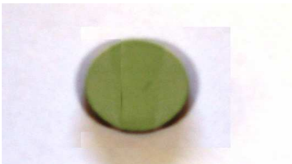
Figura 5 - Pastilha de zirconita dopada com cromo, tonalidade verde.
