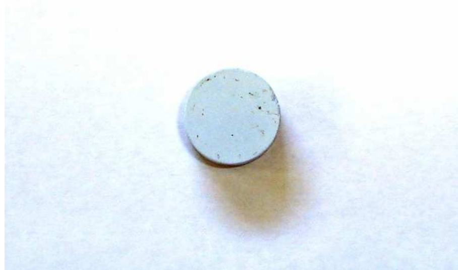
Figura 4 - Pastilha de zirconita dopada com cobalto, tonalidade azul.
